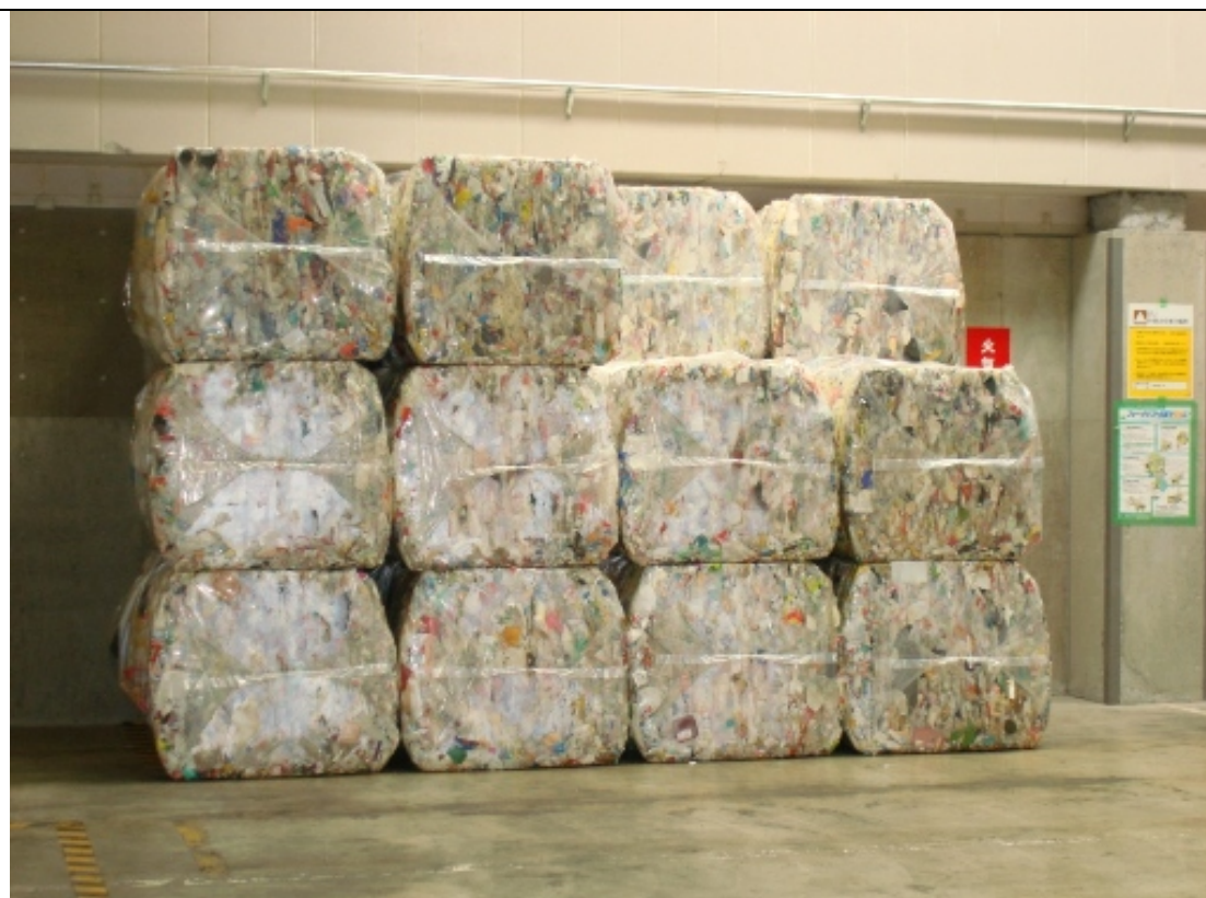
經過壓縮捆包機將回收物壓成一立方公尺，以方便載運
