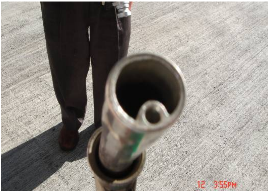
照片二十：加油槍中的油氣回收設施
