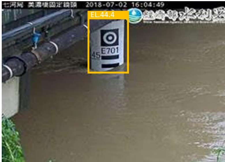
圖 19 橋墩水尺之水位辨識示意圖
