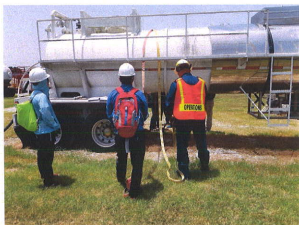
照片 27：圖為 cargo tank leak containment 操作 流程，當槽體有破損(punch)時，使用 air bag 加壓止漏。
