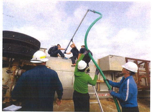
照片 32：圖為 cargo tank cold tapping 操作流程，將抽取用管線置入側翻槽車內進行汲取。
