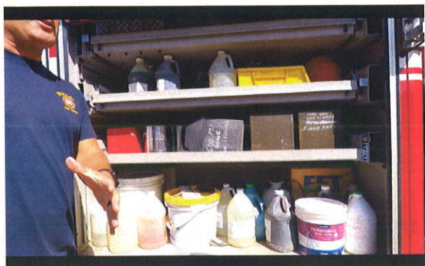
照片 11：參訪達拉斯市化災分隊(station 3)，圖為化災車上清消器材，各種化學藥劑作為除汙、中和之用。
