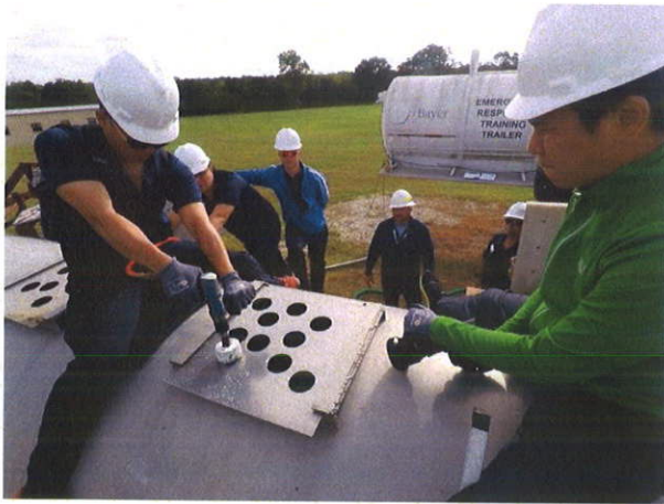
照片 31：圖為 cargo tank cold tapping 操作流程，於側翻槽車切割開口並以水霧防護。
