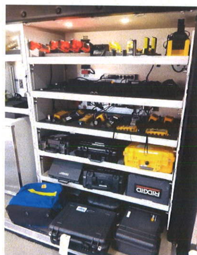
照片10：參訪達拉斯市化災分隊(station 3)，圖為化災車內器材室，備有無線電、照明燈、各種氣體探測器等裝備。
