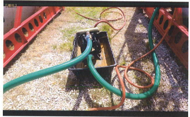
照片 44：圖為 non-pressure IMO transfer 操作流程，加壓幫浦連接方式。
