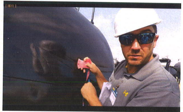
照片 56：圖為 tank car damage assessment 操作流程，使用 dent gauge 來辨識彎曲程度。
