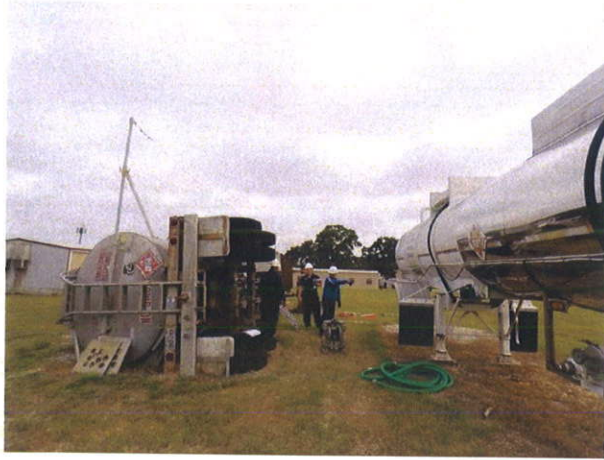
照片 29：圖為 cargo tank cold tapping 操作流程，適用於鋁製槽車側翻事故移槽作業。
