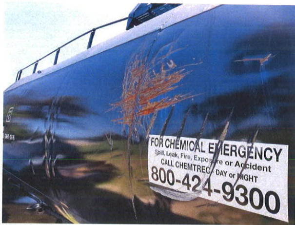
照片 55：圖為 tank car damage assessment 操作流程，學習辨識受損情形以評估是否需進行移槽作業。
