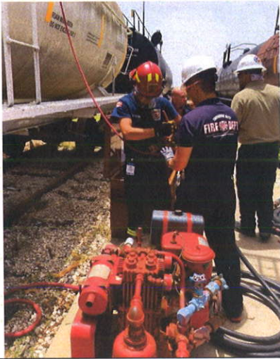
照片47：圖為 tank car transfer liquefied gas 操作流程，因 tank car 較高，須以繩索固定器材吊上槽車使用。
