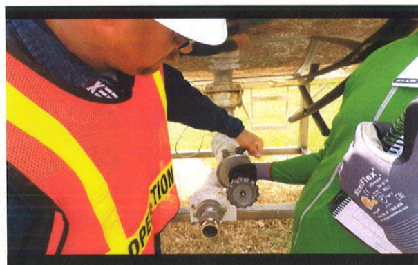
照片 26：圖為 cargo tank external valve repair 操作流程，當有物質洩漏時，需正確 更換墊片完成止漏。
