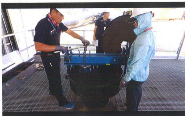
照片51：圖為 tank car midland kit 操作流程，選擇適當大小的 hood，鎖上 legs、strong back。
