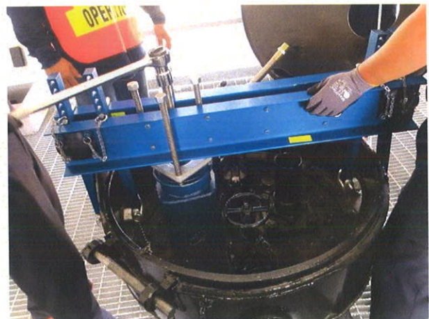
照片52：圖為 tank car midland kit 操作流程，將螺絲鎖緊，撐頂 strong back 達到止漏效果。
