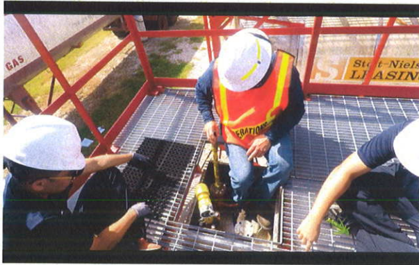
照片 43：圖為 non-pressure IMO transfer 操作流程，上方閥類包含蒸氣閥及液體閥。
