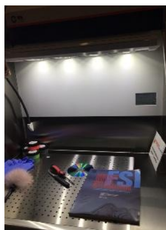
照片 8：具有下方抽風設備的指紋粉末工作臺
