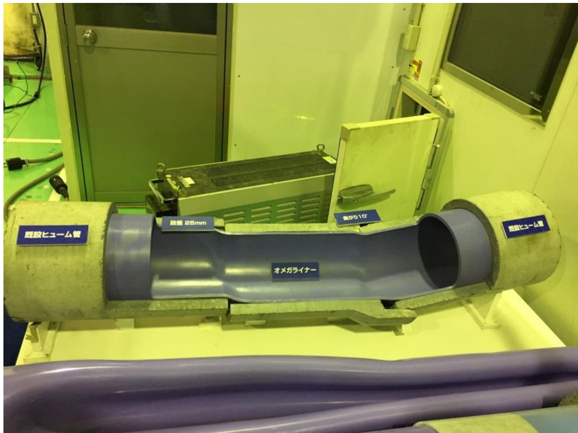
記憶内襯工法完成品
