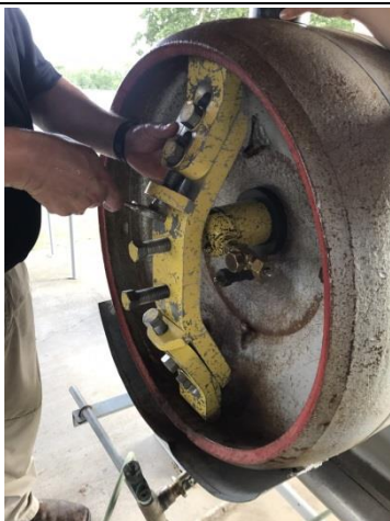
照片35：圖為SPANCER教官示範鋼瓶容器如身裙側時，如何利用專用止漏器具(KIT B)進行內部容器法止漏作業。
