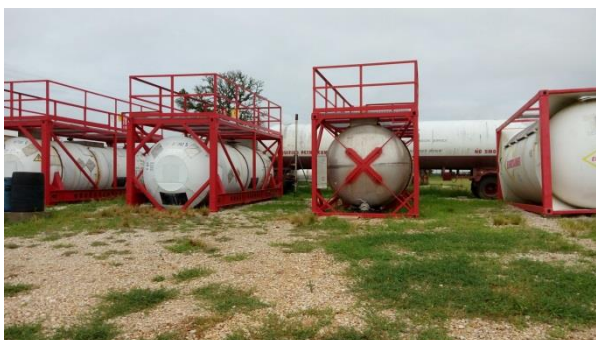
照片9：圖為各式移動式儲槽，可由其槽體兩端結構形式(平面式、圓形凸起等)判斷為低壓、高壓等不同形式槽體。
