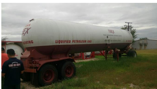
照片11：圖為MC-331型槽車，常用於裝載液化高壓氣體(如液化石油氣)，其槽體外觀兩側常呈現圓球狀，最大允許工作壓力設計在100-500psi間。
