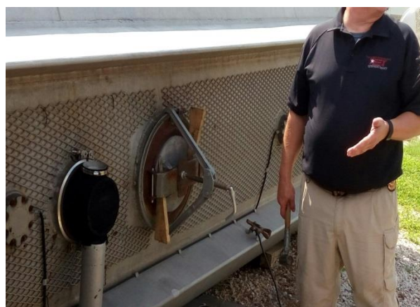
照片20：圖為SPANCER教官講解槽車洩漏止漏要領，示範利用止漏專用器材進行槽車閥門止漏步驟(以DOT306槽車為例)。
