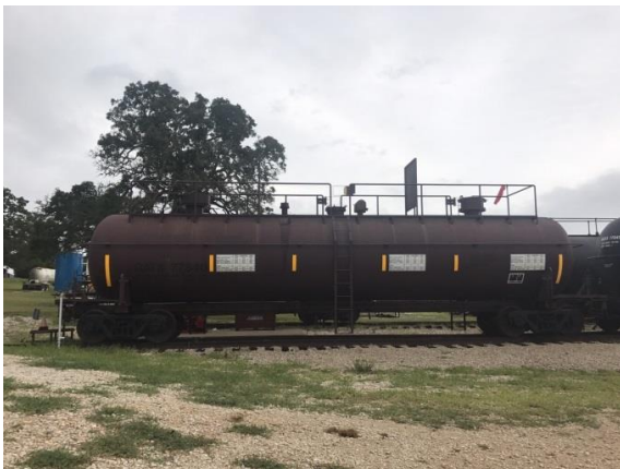
照片1：圖為一般槽車(鐵路運輸)，可用來裝載多樣危險或非危險物質，在辨識上可以從槽體頂端的閥為開放式的做識別，內部壓力在25psi以下。
