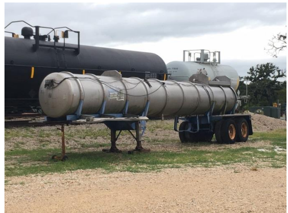
照片4：DOT412、MC312型槽車，常用以裝載腐蝕性液體，其外觀特徵槽體直徑較小且有加強結構的環狀加強環，最大允許工作壓力在15psi以上。
