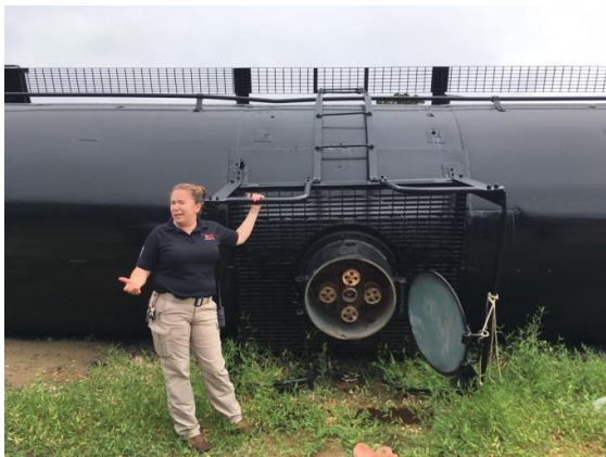
照片3：壓力槽車(鐵路運輸)的4個開關閥會用同一個護蓋內，與槽車行進方向相同的為液態閥，垂直方向的為氣態閥，中間則為安全洩壓閥。
