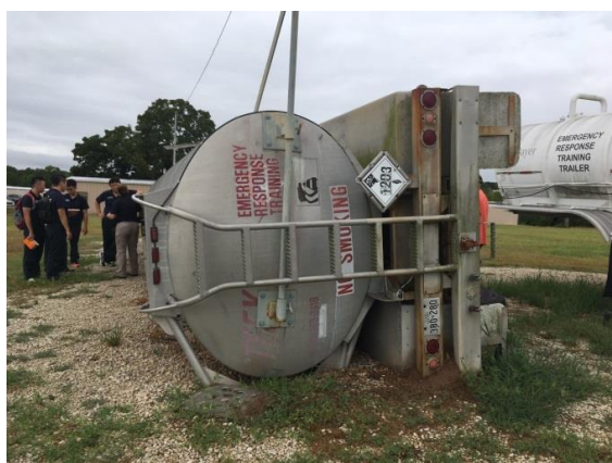
照片5：MC-306、DOT-406型槽車，常用於裝載易燃性液體(如汽柴油)，頂部有翻覆保護裝置，底部則有卸載閥，最大允許工作壓力介在3-15psi。
