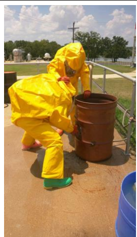
照片29：圖為本局訓練人員實際穿著A級防護衣操作儲桶止漏作業，利用止漏用專業黏土快速進行止漏作業。
