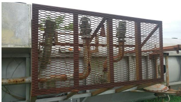
照片7：MC-306、DOT-406型槽車底部設置有卸載閥，通常一個內部槽體配置一個卸載閥。
