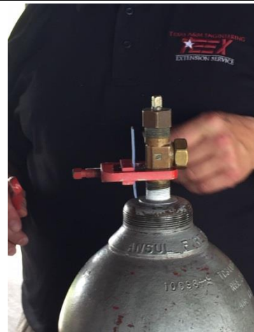
照片32：圖為SPANCER教官示範鋼瓶容器閥變形洩漏時，如何利用專用止漏器具(KIT A)進行容器閥止漏作業。
