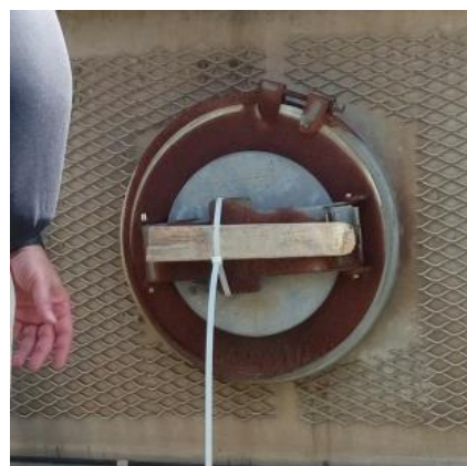
照片22：圖為SPANCER教官講解槽車洩漏止漏要領，示範手邊無專用止漏器材時，如何以束帶及木栓進行槽車閥門止漏步驟(以DOT306槽車為例)。
