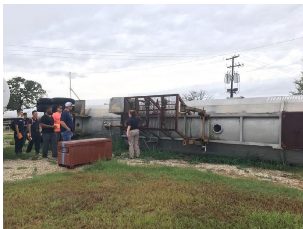
照片8：教官正在介紹MC-306、DOT-406型槽車，並加強提醒此類型槽車為濕式裝載槽車，需特別注意底部管路燃料殘存的問題。
