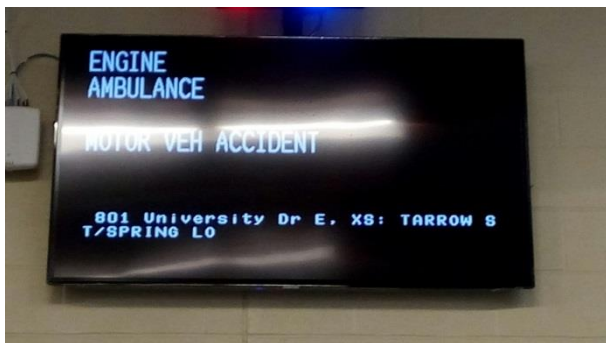
照片11：圖為當地消防隊於車庫或外牆等吵雜處，設置案件出勤資料顯示面板，讓在戶外活動同仁能立即知道案件狀況。
