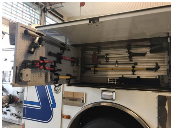
照片4：為當地消防隊化災事故應變指揮車，內部裝置各式破壞器材，其空間設計使得車輛裝載空間利用大幅提升，值得我國消防車參考。
