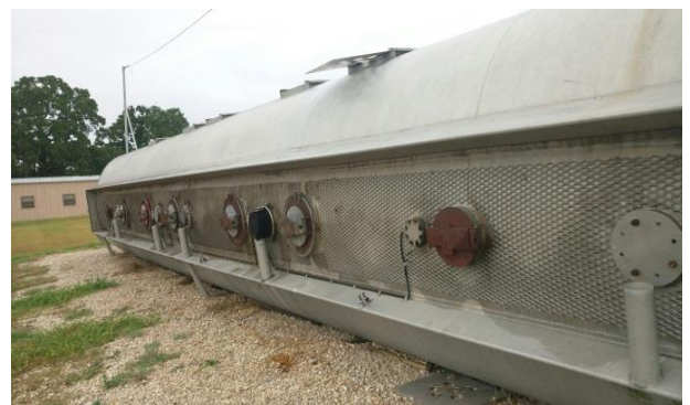
照片6：MC-306、DOT-406型槽車可由頂部閥門設置數量判斷內部槽體數量，其兩側設有翻覆保護裝置。
