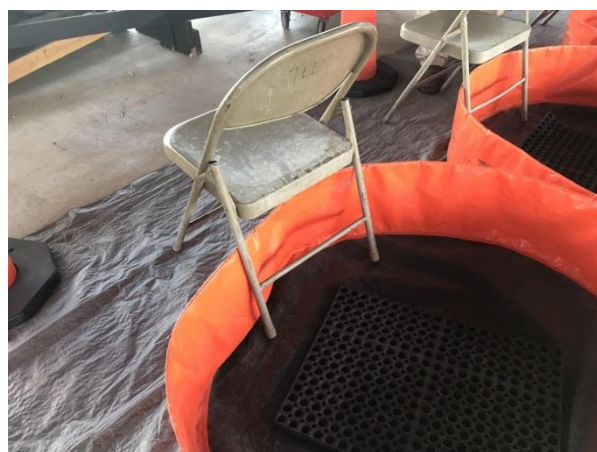
照片40：圖中椅子係讓被汙染人員於除汙過程中避免重心不穩或絆倒，導致於除汙過程中造成廢液飛濺及二次汙染。
