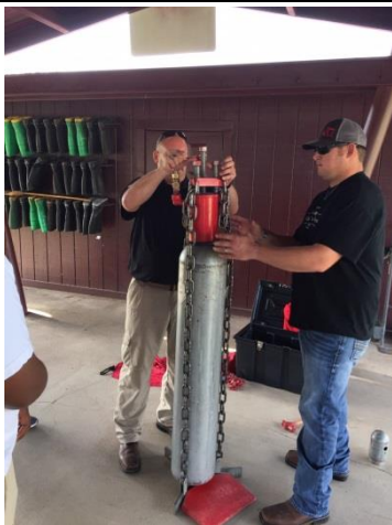
照片33：圖為SPANCER教官示範鋼瓶容器如鋼瓶容器閥嚴重洩漏無法利用圖8工具止漏時，如何利用止漏器具(KIT A)進行容器閥氣密止漏作業。
