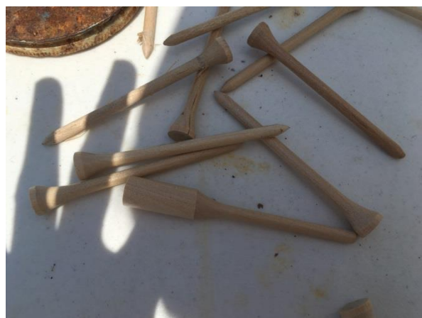
照片26：圖為本次訓練止漏用不同尺寸木栓，針對小型洩漏點作快速填塞止漏。
