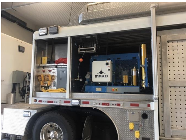
照片3：圖為當地消防隊化災事故應變指揮車，該車具備有空氣壓縮機，經由濾心等清淨功能後，可於災害現場適當地點進行空氣呼吸器填充。
