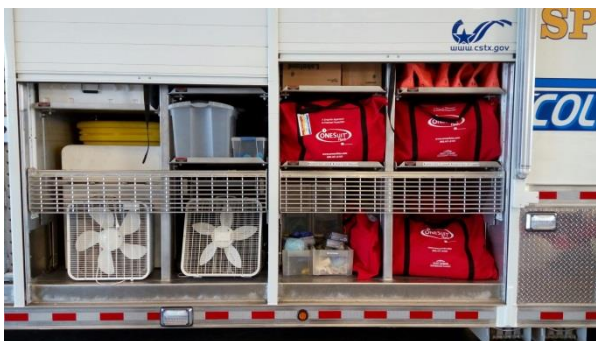
照片5：圖為當地消防隊化災事故應變指揮車，內部配有A級防護衣等化災應變裝備，其中風扇為考量人員輪替時休息散熱用。
