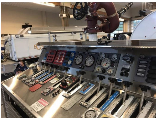
照片7：圖為當地消防隊消防車多功能操作介面。
