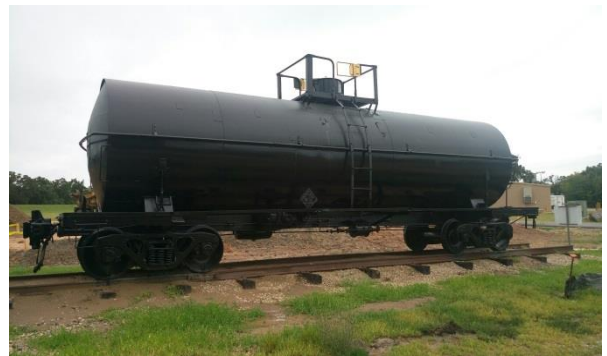
照片2：圖為壓力槽車(鐵路運輸)，用來裝載可燃、不可燃、有毒或液化石油氣，其頂部閥門有護蓋作為保護裝置，內部壓力常在40psi以上。
