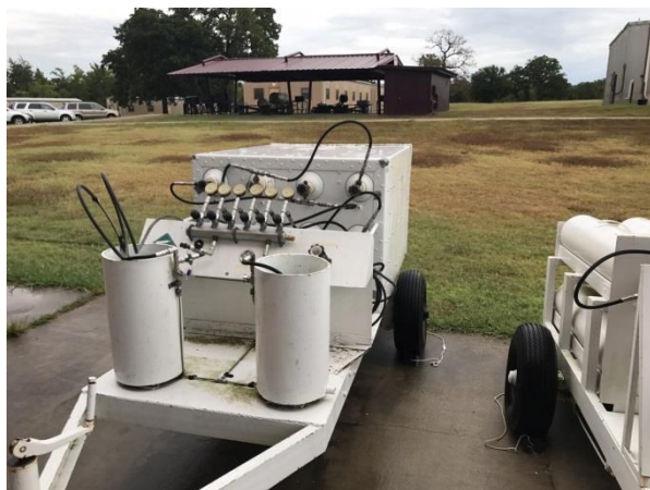
照片53：圖為TEEX訓練中心空氣呼吸器移動式充氣車，使填充氣瓶更快速有效率。
