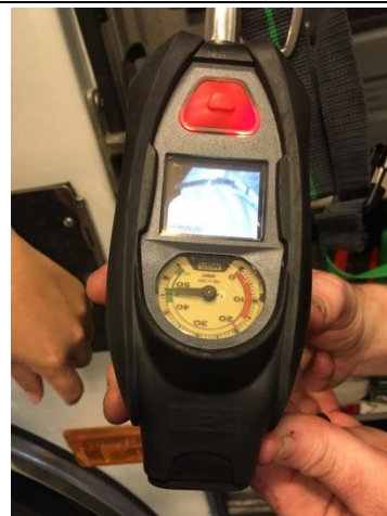
照片8：圖為當地消防隊所使用之熱顯像儀，其設置於空氣呼吸器背架上連結壓力表，體積極小，使用上方便快速。
