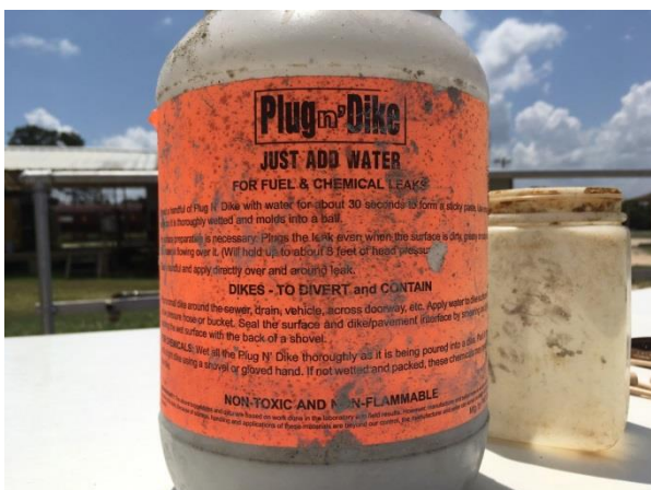
照片25：圖為本次訓練止漏用專業黏土，平時為乾燥粉末裝於塑膠瓶內，使用時將乾燥黏土與水混合，即能快速進行止漏作業，均勻塗抹於洩漏孔後止漏效果極佳。
