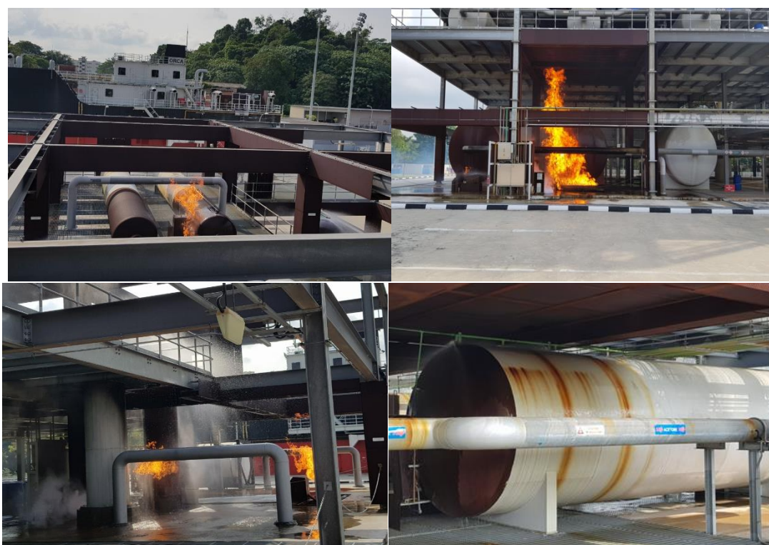
圖 41. 化工廠模擬訓練場景-各設施洩漏、爆炸與起火情境
