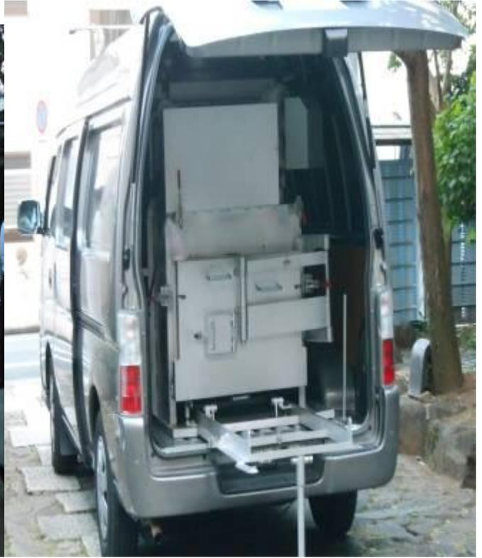
圖 68. 感應寺的二輛移動式火化車皆配備有動物屍體火化設備
