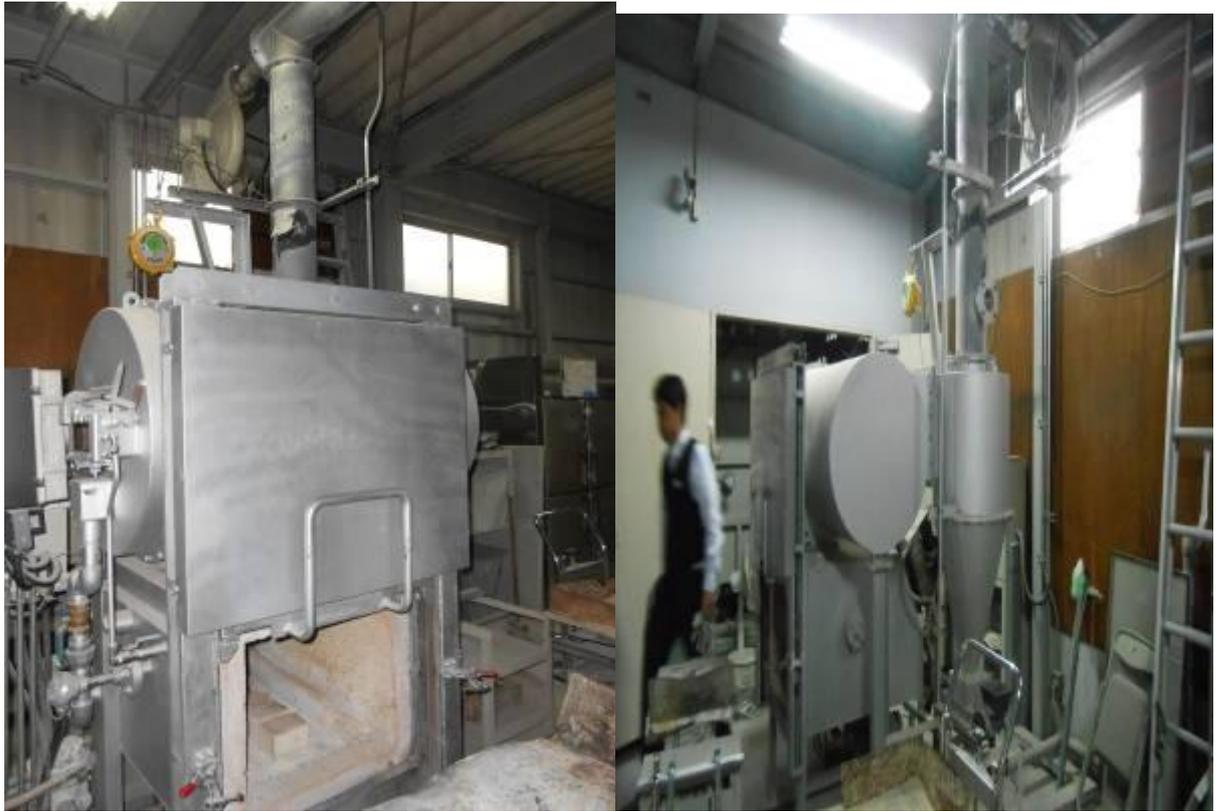
圖 127 動物屍體火化爐有 2 大 1 小共 3 座，每座動物屍體火化爐皆配備有空氣污染防制設備
