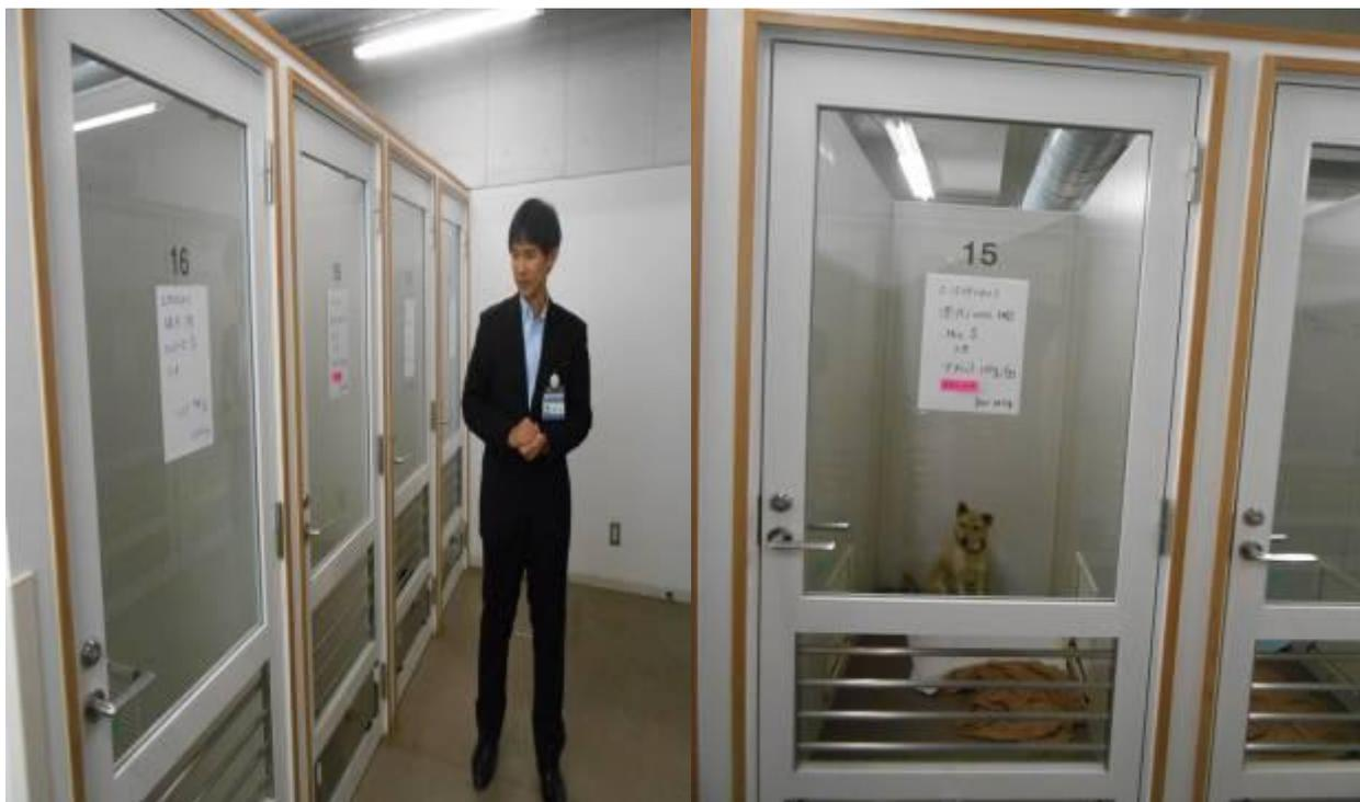
圖 93 橫濱市愛護動物中心罹病犬之隔離觀察室，共有 16 間，採單隻獨籠飼養方式，籠舍門口上方採透明玻璃設計，下方則有互動觀察孔及餵食區入口，方便動物管理員觀察與餵食(藥)照顧
