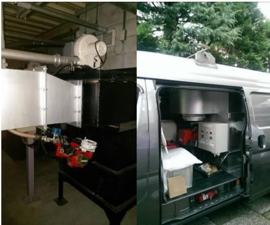
圖 67. 感應寺的固定式動物屍體火化爐及移動式火化車皆配備有空氣污染防制設備，以確保動物屍體進行火化時的環境空氣品質
