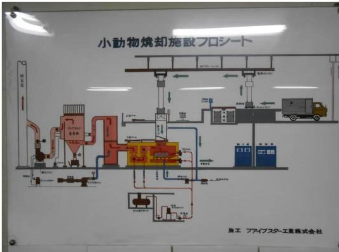
圖 141 橫濱市戶塚殯儀館寵物屍體火化爐設施平面圖（包括動物屍體安置台、動物屍體懸吊系統、冷凍櫃、進爐收集口、一次燃燒機及二次燃燒機、冷卻系統、集塵系統等空氣污染防制系統）
