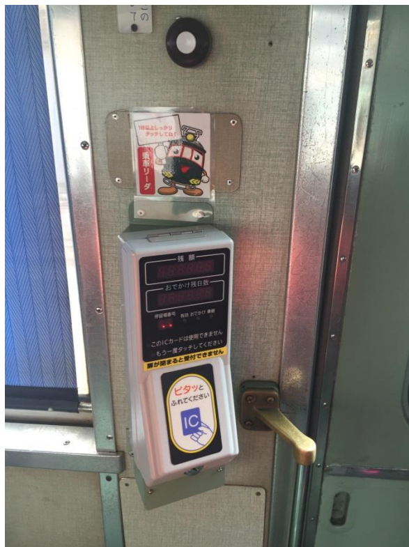
▲驗票系統：月台無設計驗票閘門，僅於車上安裝票證設備，採取下車收費。
