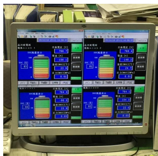
▲ 電力系統：監控電力系統供電情形，有常用及備援 2 種，通常備援不會供電，常用的有異常備援才會供電。紅色：表示通電；綠色：表示不通電。
