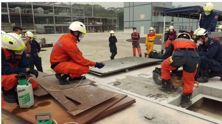
2. 根據破壞方式、水泥強度來選用適當鑽頭。
