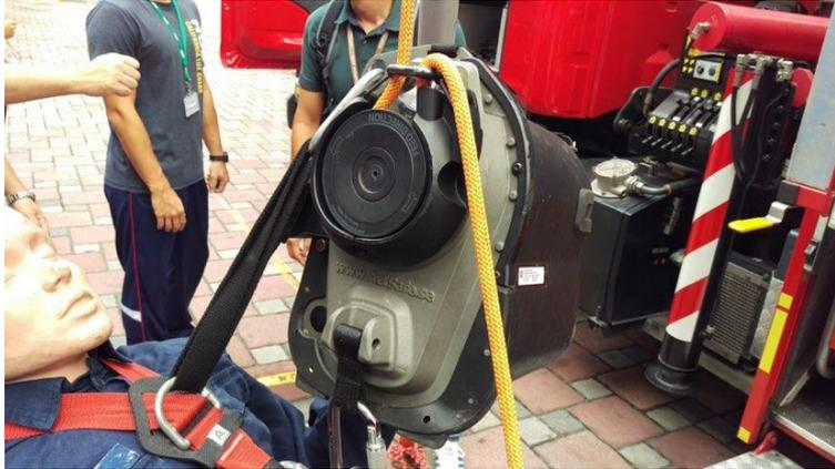
由救助手自行操控的電池式絞盤機屬於工業用絞盤機，電池可更換且為防水。
