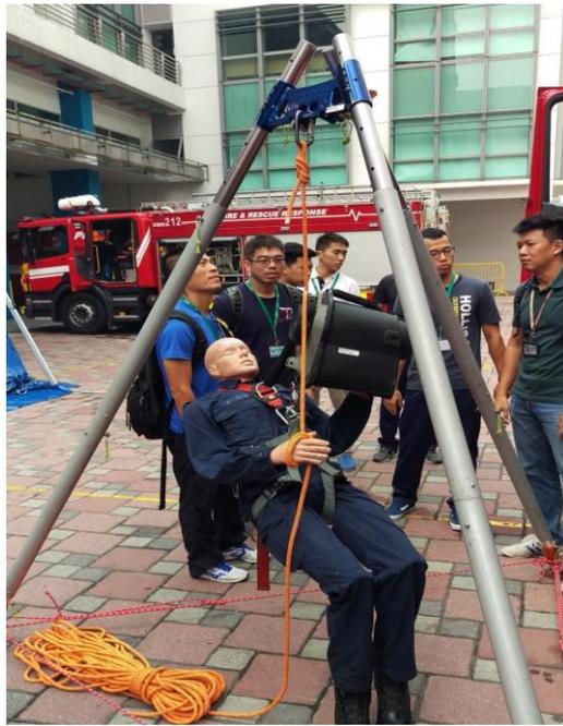
三腳架與絞盤機合併使用，將成為低所救助之利器。
