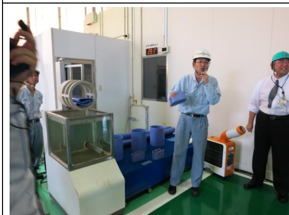
展示蒸氣加熱更新管線方式(將扁平管材放入老舊管線內，利用蒸氣或熱水使其膨脹恢復圓形管狀)
