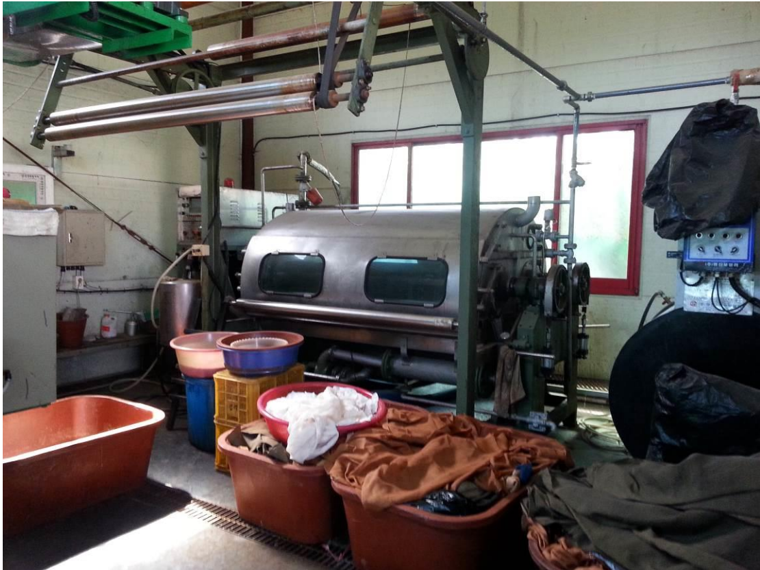
染布機一次可以染 600 公斤柿染布，多提供給寢具公司或服裝加工公司
