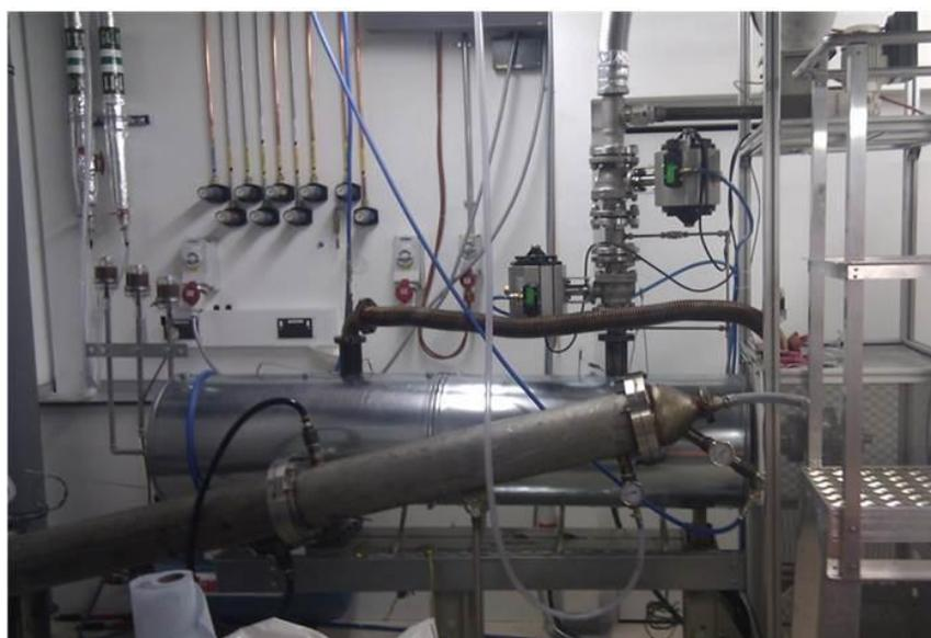
圖 56、歐洲生質能源研究所實驗室內汽化儀器
