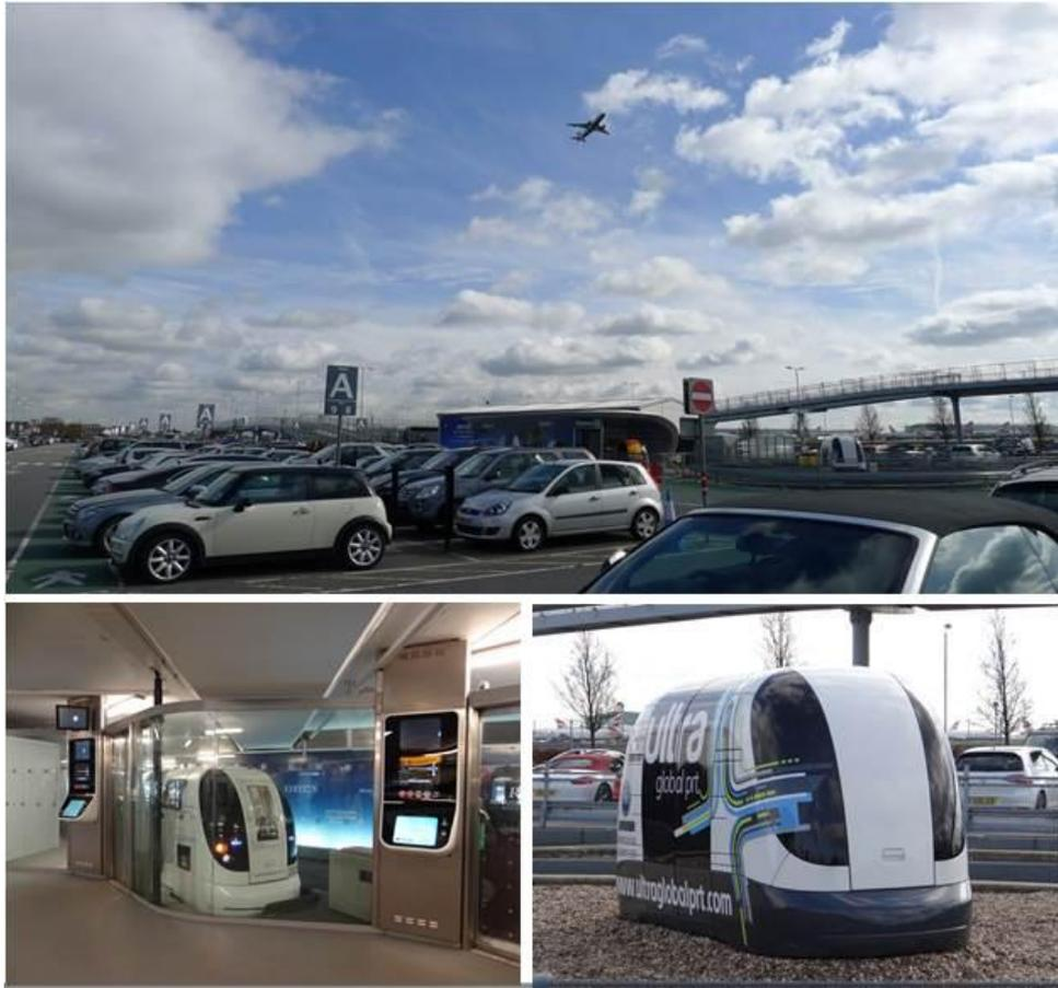
圖 63、個人快速交通系統的車輛與車站
