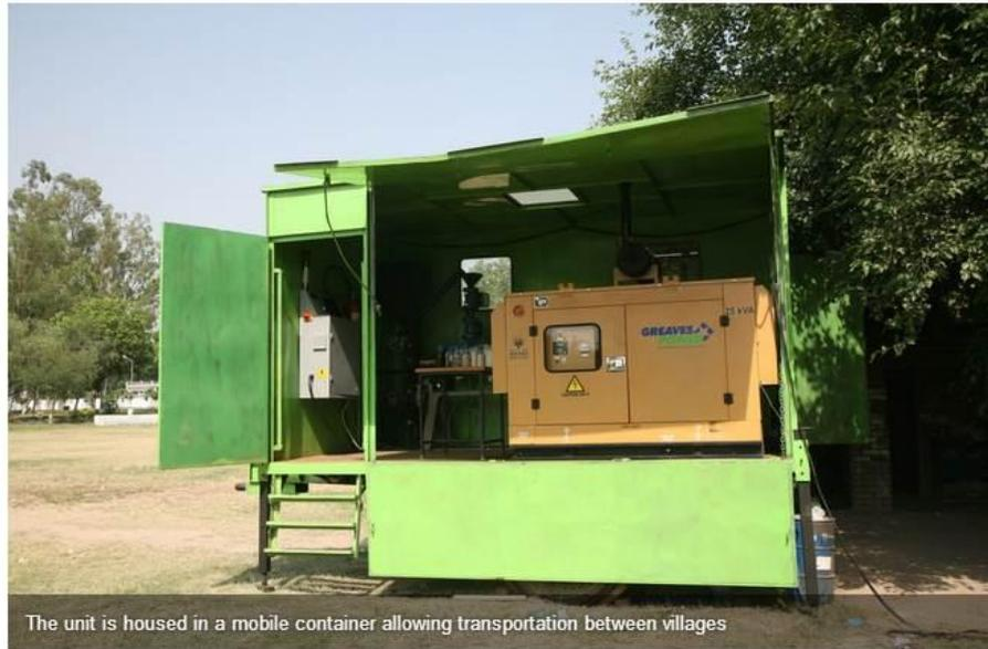
圖 54、歐洲生質能源研究所計畫團隊研發移動式 Pyroformer™
