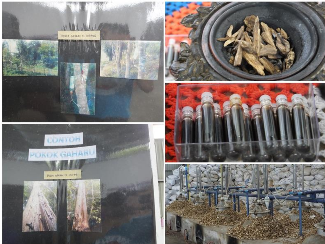
(圖 32 沉香精油蒸餾工廠提煉過程及產物)
