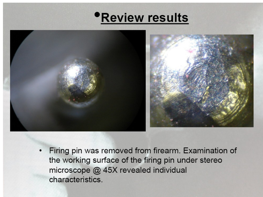
圖二、撞針表面上的顯微特徵 1
