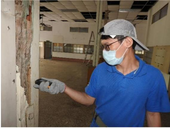
圖 4.3.10 量測木構件含水率
