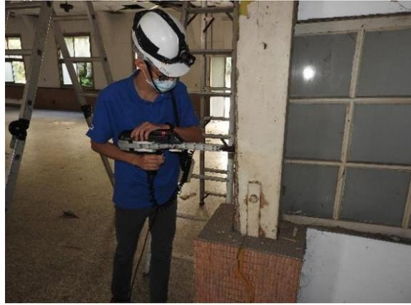
圖 4.3.11 以鑽孔阻抗儀檢測木構件內部狀況
