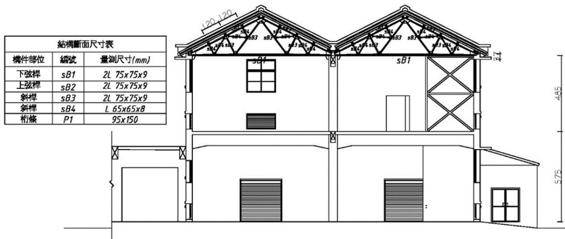
圖 4.2.256 芬克式桁架\_結構分析斷面尺寸
