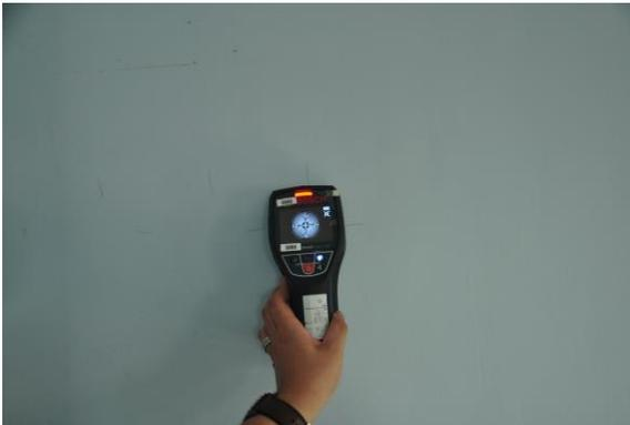
圖 1.2.16 儀器顯示掃描到牆體內鋼筋
