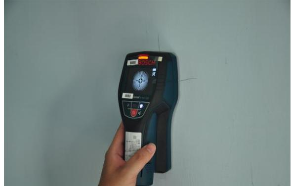
圖 1.2.15 儀器顯示掃描到牆體內鋼筋
