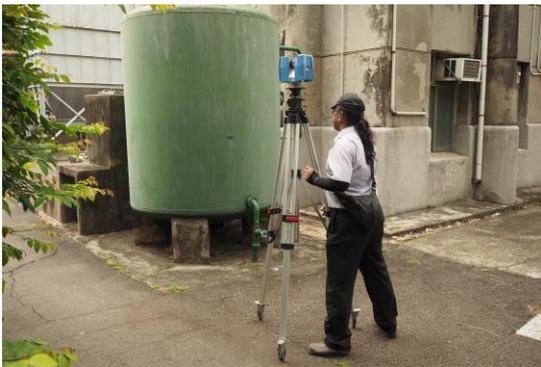
圖 1.2.6 點雲掃描作業狀況-汽罐室
