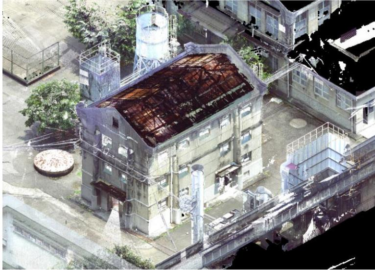
圖 1.2.9 點雲掃描初步成果-西北透視-汽罐室
