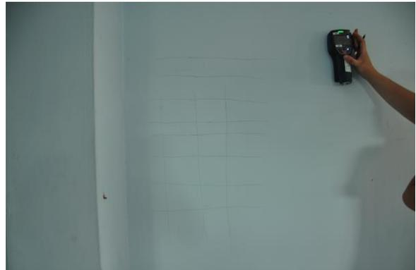
圖 1.2.17 依掃描結果初步描繪出現鋼筋反映位置
