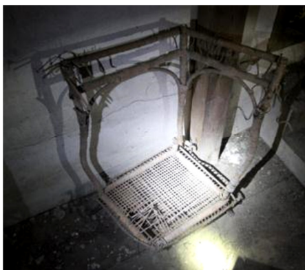
【照片 1】邊几整體明顯壓迫變形
