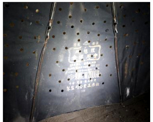
【照片 3】洋傘支撐桿彎曲
