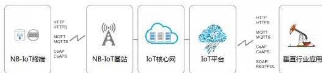
圖 4-1 NB-IoT 整體架構
