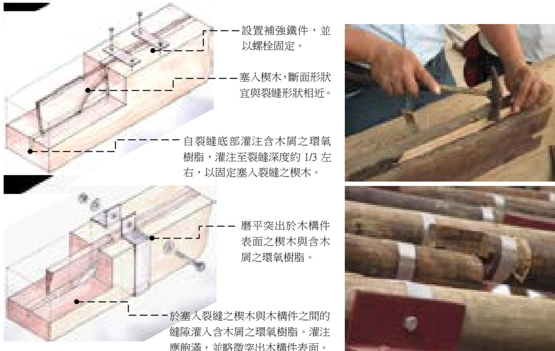
圖 7-10 木構件包覆鐵片以及縫隙填補同材質木料
