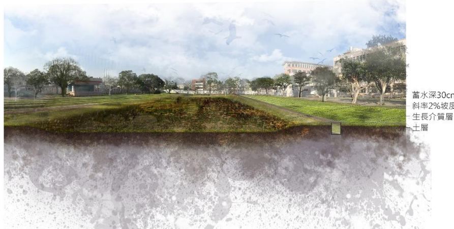
圖 5-2-6 乾式滯洪池策略示意圖
