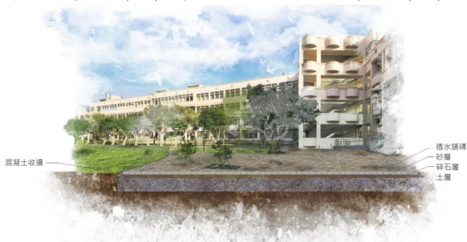
圖 5-2-12 透水鋪面策略示意圖
