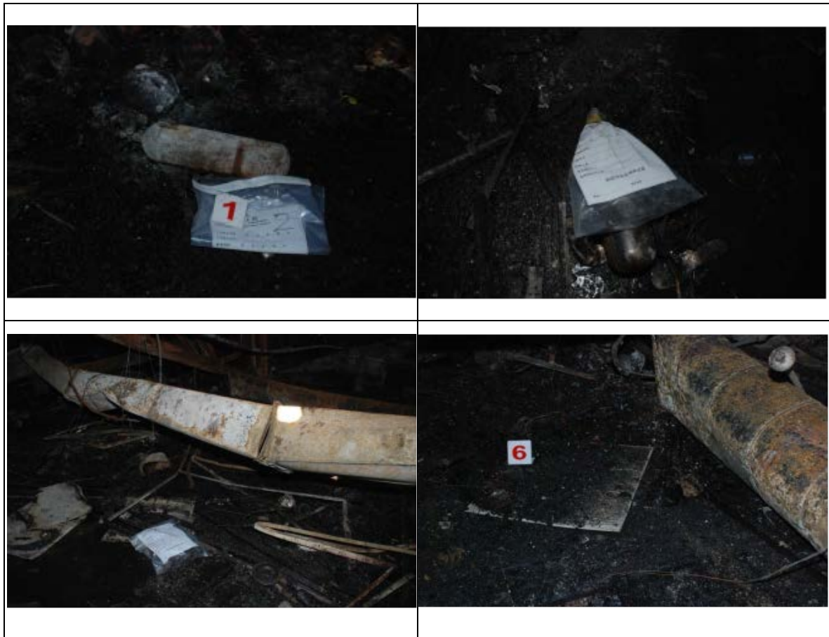
圖 3-14 空氣瓶及裝備受損情形採樣
