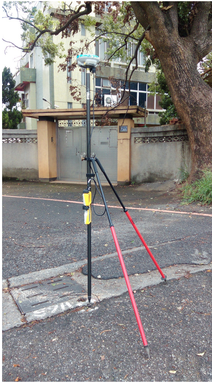
圖 11：透空率影響 e-GNSS 定位現況圖
