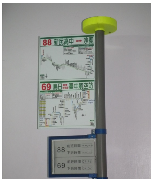
圖 5-15 由傳統站牌改裝成的電子紙智慧站牌全貌
