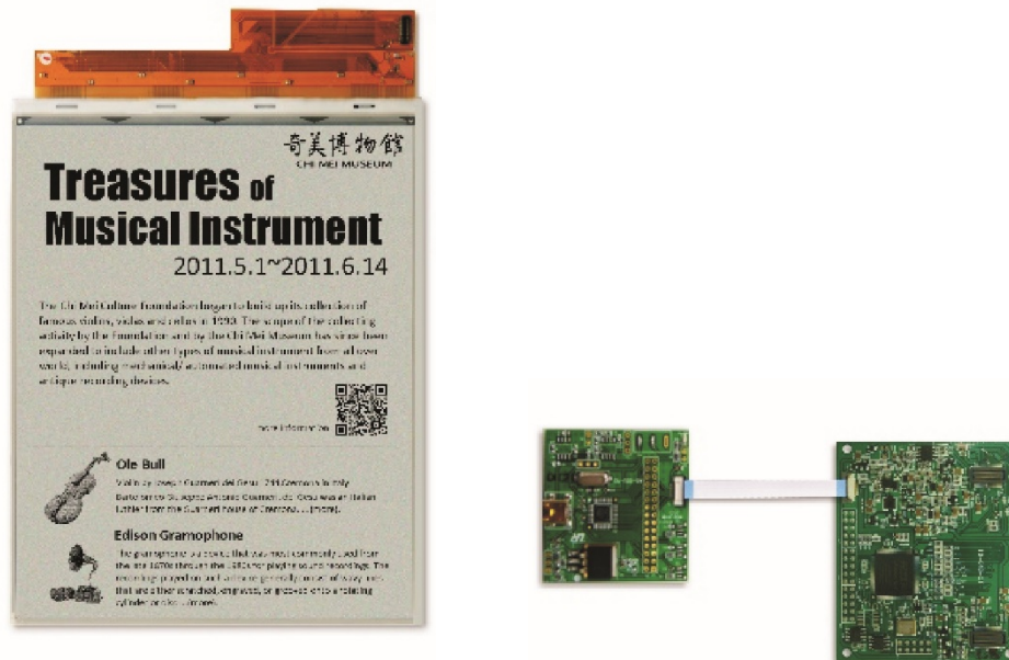
圖 5-7 奇美電生產的 10.1”電子紙面板及控制模組
