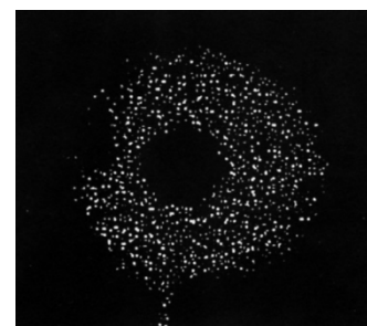
圖 8. 反射稜鏡所產生之點雲外擴及中空情形(摘自地面光達掃描定位原理與誤差分析 P7)
