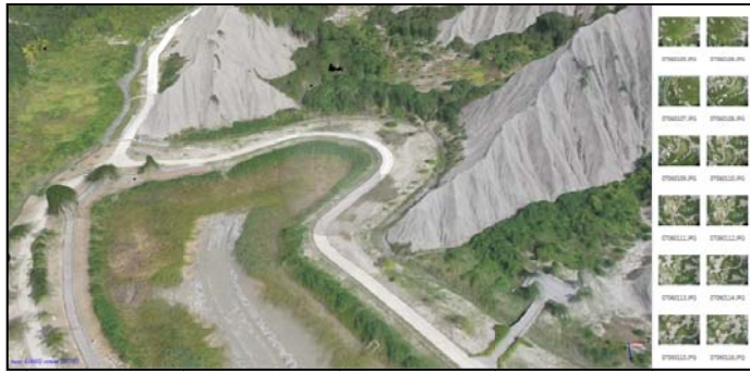
圖 12. 照片轉換成彩色三維立體模型(摘自力弘科技)
