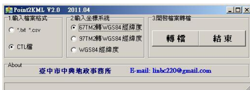
圖 3.12、控制點坐標轉換程式操作介面
