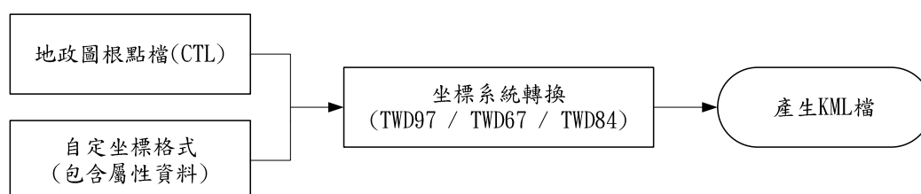
圖 3.11、控制點坐標轉換程式操作流程
