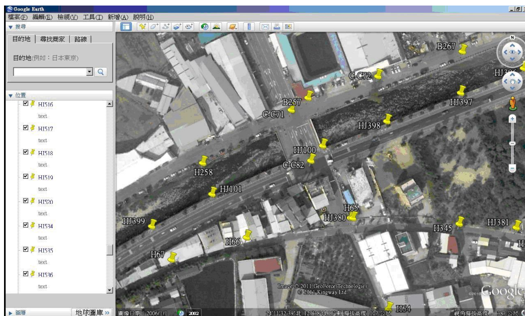
圖 3.13、轉換後的圖根點位置與影像套合圖
