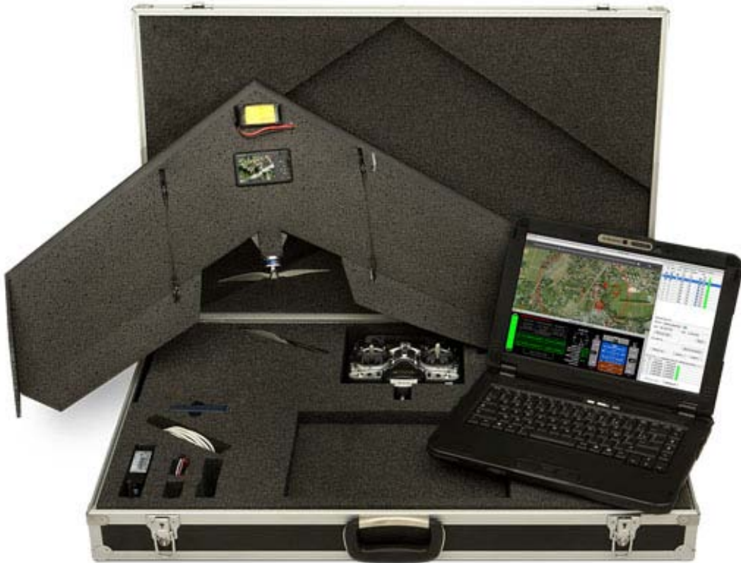
圖 10：無人飛行載具（UAV）
