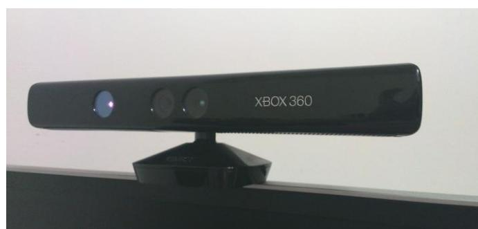
圖 2.1、Kinect 感測器硬體
