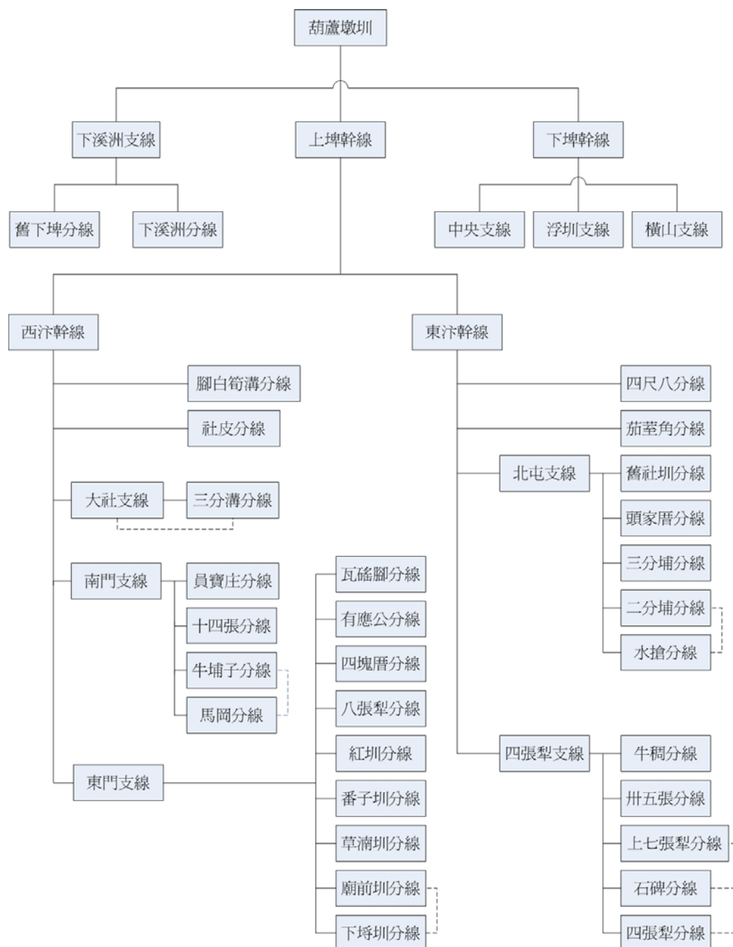
圖 3-2 1964 年葫蘆墩圳圳路層級系統圖
