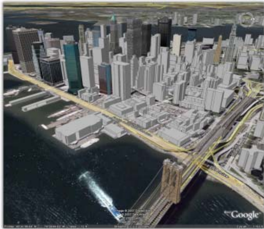
圖五、 美國紐約曼哈頓島一隅三維景觀，包含重點指標性建築物與一般簡單化之建築物模型。(右下角為 Brooklyn Bridge 之三維模型)
