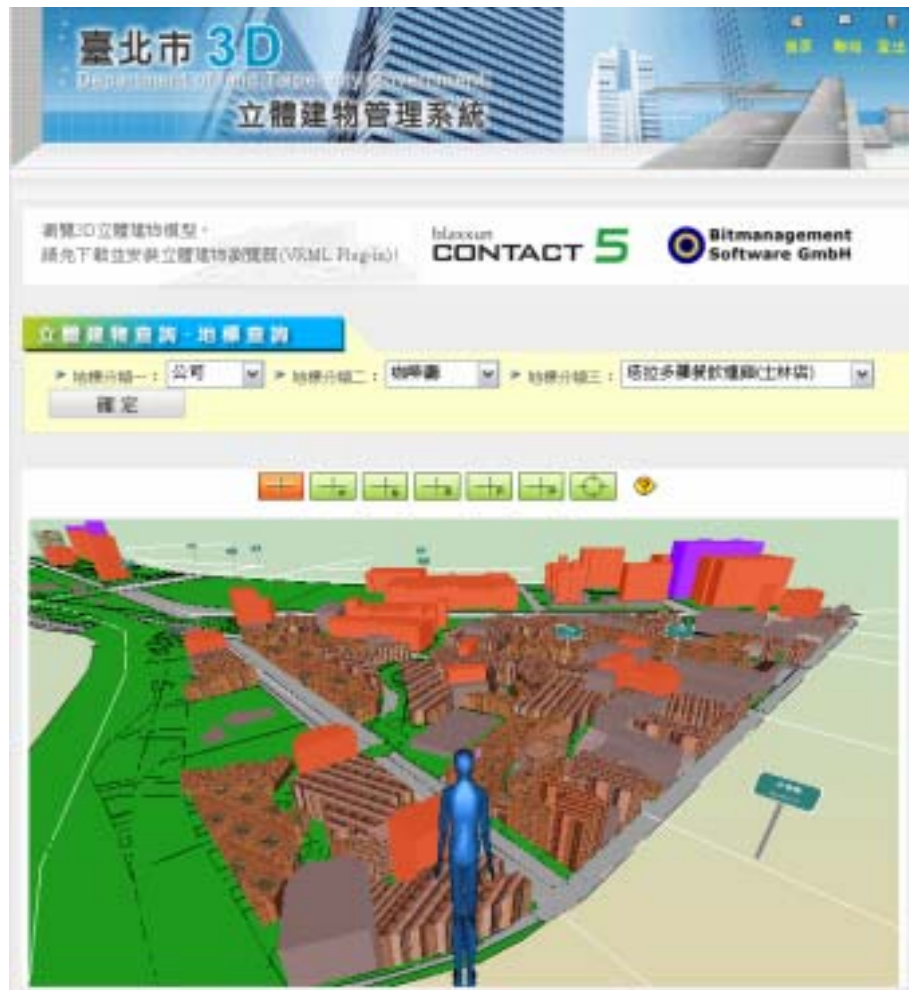
圖七、 台北市政府立體建物查詢，北市已將全市建物建立三維模型資料庫，點選建物並可直接連接建物測量成果圖與開啟相關資訊網頁。唯模型組成較不精細、外觀材質與現實不符，所使用平台較不易親近。
