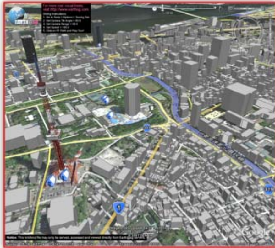
圖四、日本東京一隅(左下角建築為東京鐵塔)，除了針對具特點之指標性建築物建立細緻、貼附外觀材質三維模型資料外，對於一般建物亦建立全面性的簡單模型，對整個城市有一個立體的概觀視景供使用者參考，網路瀏覽速度合理。
