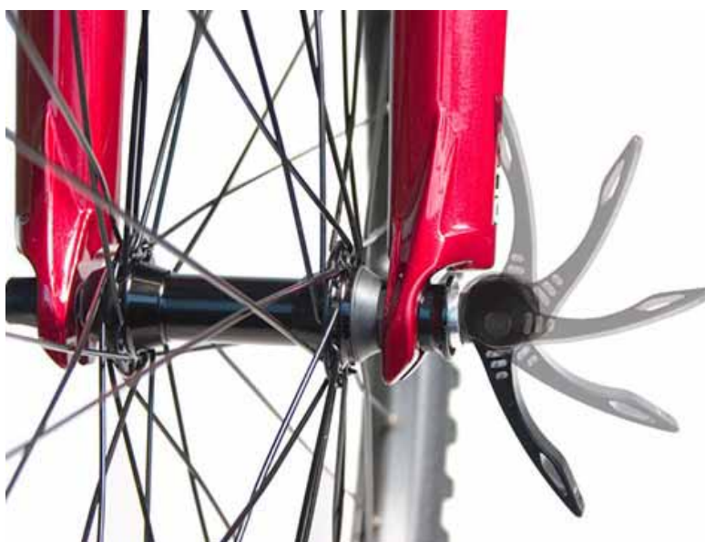
圖2-2 自行車車輪快拆設計
