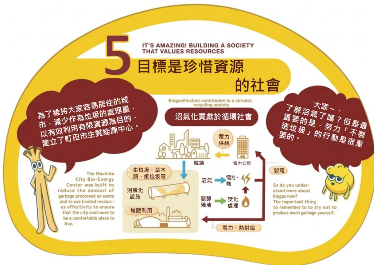
圖 25、町田市熱能回收中心環教設施講解厭氧發酵設施原理(5/5)
