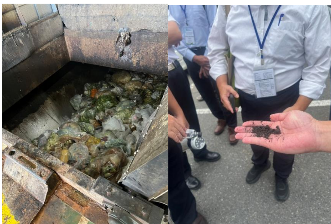
圖 40、有機廢棄物投入口近照（左）及發酵後沼渣（右）
