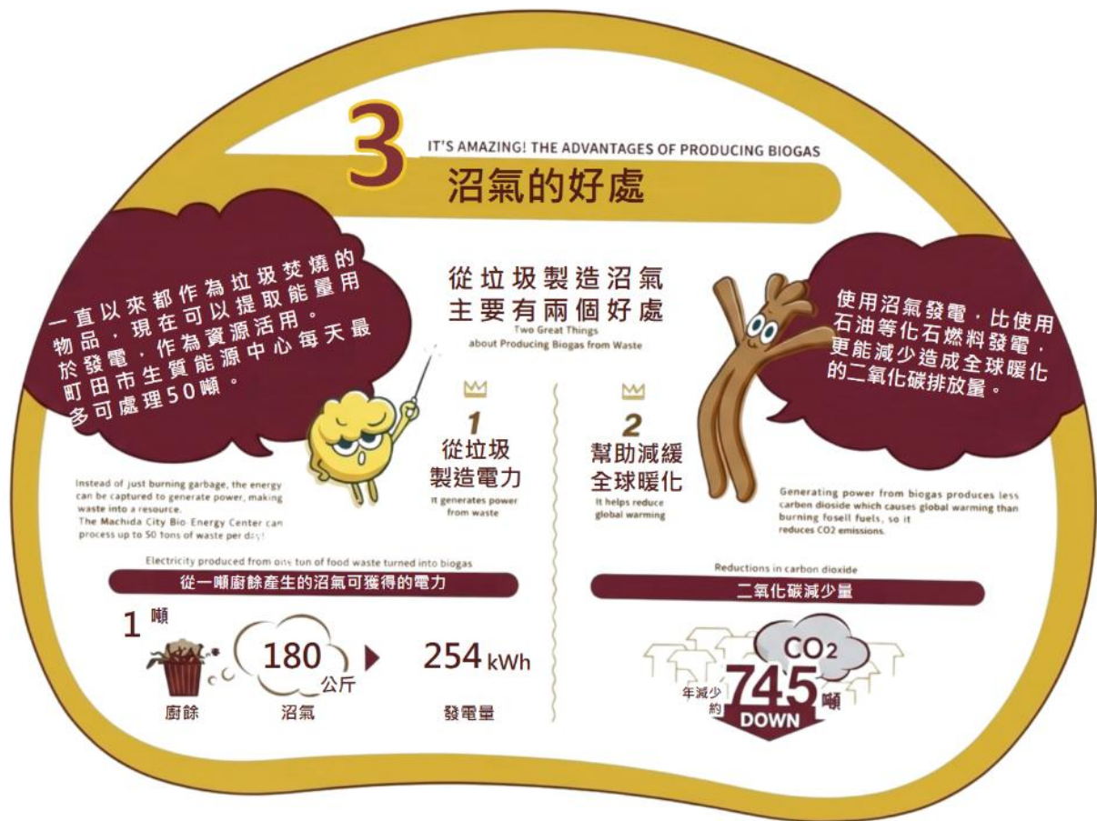
圖 23、町田市熱能回收中心環教設施講解厭氧發酵設施原理(2/5)
