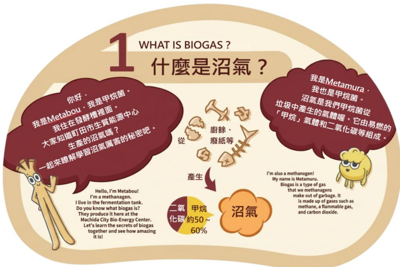
圖 21、町田市熱能回收中心環教設施講解厭氧發酵設施原理(1/5)
