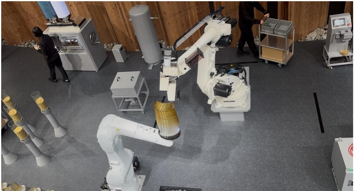
圖 37 工廠區機械手臂，打印出組合座椅
