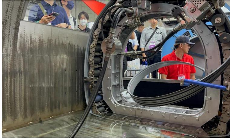
圖7 SPR-RE 工法現場示範製管操作
